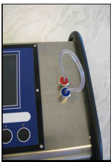
FOTO 26. Instrumento limpio con el sistema cerrado.
