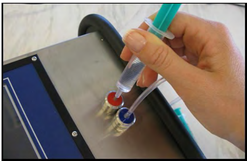
FOTO 24. Inyecte el líquido limpio en sentido opuesto a la dirección del líquido.
